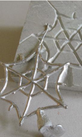
Aus einer Konservenbüchse, etwas Draht, einer Eisenstange und einem Stück Holz bauen wir einfache Giesskellen. Auf einer Brockenstuben-Tour erstehe ich alte Zinnbecher, die wir in kleine Stücke zerteilen und später über dem Lagerfeuer einschmelzen.
