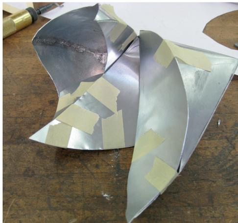
Verschiedene Bearbeitungstechniken wie sägen, schleifen, biegen und treiben werden an diesem Übungsstück erprobt und angewendet.
