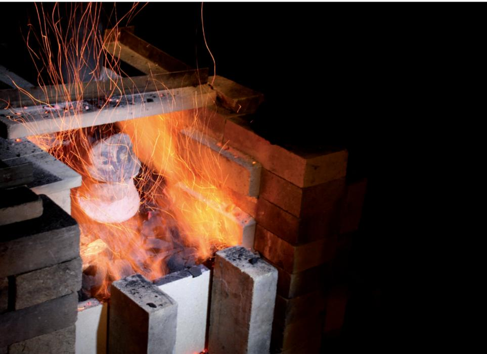
Der zeitintensive Vorgang des Gelbgiessens wird von der Anfertigung des Wachsmodells, über die Herstellung der Gussform bis hin zum Bau des Ofens Schritt für Schritt durchgespielt. Die Wahl der Form ist uns selbst überlassen. Ich versuche mich an einem Hohlkörper. Die durchbrochene Oberfläche ist notwendig, um am Schluss den Kern herauszumeisseln.
